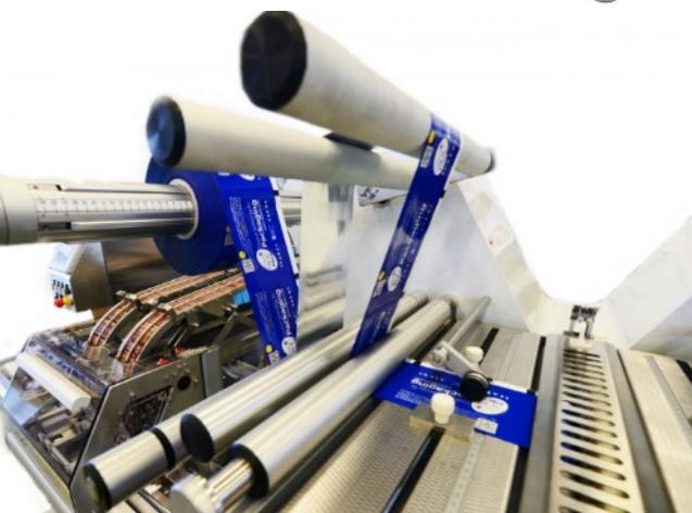
Inoltre è stata progettata la parte iniziale della macchina corrispondente all'ingresso del prodotto andando a realizzare un sistema di allineamento del prodotto completamente regolabile.
